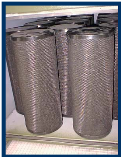
PARTICOLARE FILTRI ASSOLUTI A CARBONI ATTIVI
